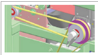
Drivning av nippvals
